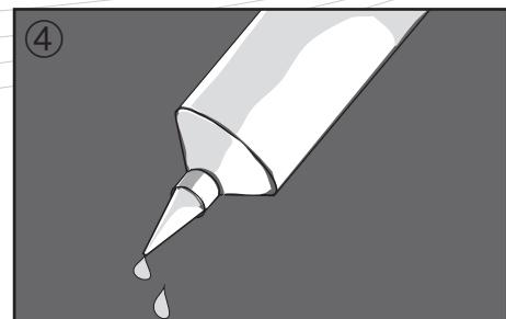
deben pegarse por encolado Stamcoll N55 o el pegamento Stamcoll AS. Agitar el pegamento en el bidón y llenar la botella de plástico. Extender el pegamento con el pincel, y presionar el conjunto. **Atención:** no dejar secar la cola, debe aplicarse húmeda. Consumo aproximado 40 g/metro lineal.
